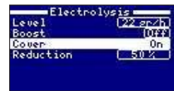
11.2 Minskning av klorproduktionen (i procent) när bassängen är stängd. Med locket stängt är det inte nödvändigt att systemet körs med 100%. Använd denna parameter för att reglera den optimala mängden klor som produceras.
