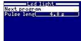
8.5 Färgval: Med denna meny kan du ändra färgen på lamporna i din pool. Alternativet Nästa program kommer att manövrera och programmera färgändringen, och med alternativet Pulsängd kan du välja den frekvens som krävs för att ändra
