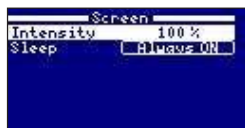
10.7 Ställer in ljusintensiteten på skärmdisplayen (0-100%) och programmerar dess ON/OFF-timer.
