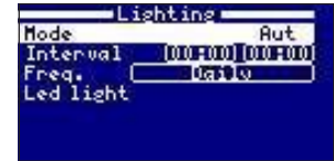
8.3 Automatiskt läge: Ställer in PÅ/AV-tid för lamporna. Tidtagarna kan konfigureras med följande frekvenser: dagligen; varannan dag; var tredje dag; var fjärde dag; var femte dag; varje vecka; varannan vecka; var tredje vecka; var fjärde vecka.
